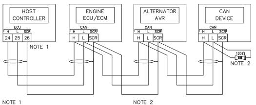
NOTE 1 AS A TERMINATING RESISTOR IS INTERNALLY FITTED TO CONTROLLER, THE CONTROLLER MUST BE THE FIRST OR LAST DEVICE ON THE CAN LINK.
