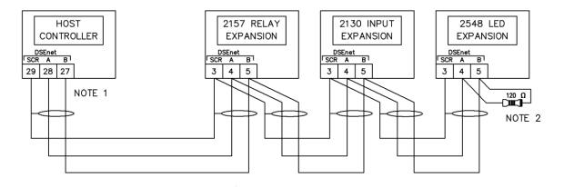
NOTE 1 AS A TERMINATING RESISTOR IS INTERNALLY FITTED TO THE HOST CONTROLLER, THE HOST CONTROLLER MUST BE THE FIRST LAST UNIT ON THE DSEnet NOTE 2 A 120 DHM TERMINATION RESISTOR MUST BE FITTED TO THE LAST UNIT ON THE DSEnet
